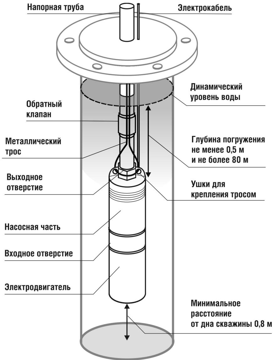
Схема расположения насоса в скважине
